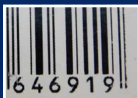
Niewłaściwy dobór rozdzielczości głowicy drukującej, błędy w szerokości kresek kodu
